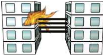
Figura 2 – Propagação entre fachadas
