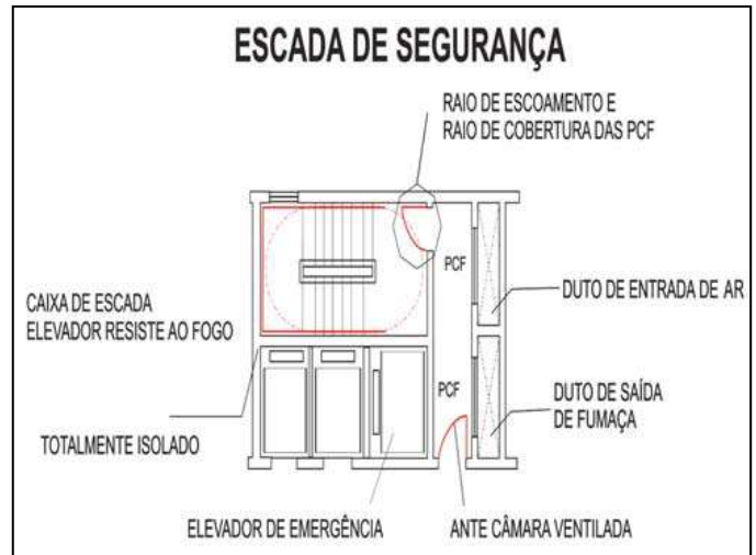
Figura 28 – Escada e elevador à prova de fumaça
