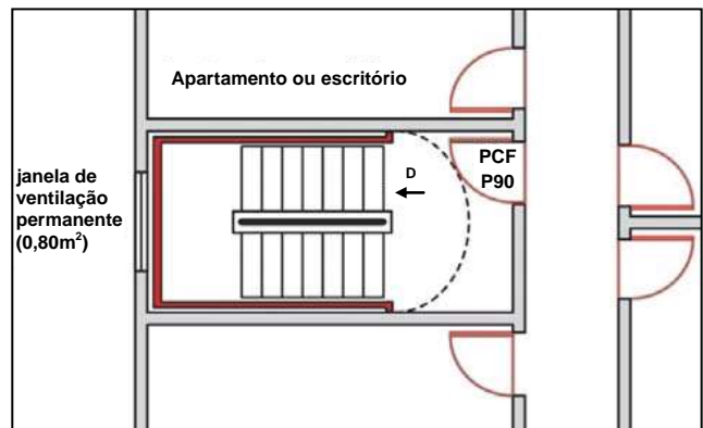
Figura 7 – Escada enclausurada protegida
